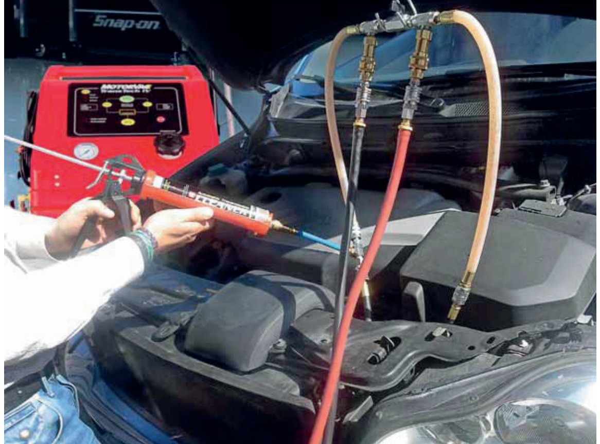
De MotorVac TransTech IV van Snap-on reinigt eerst. Al het losgeweekte vuil wordt vervolgens met de oude ATF-olie afgepompt.
